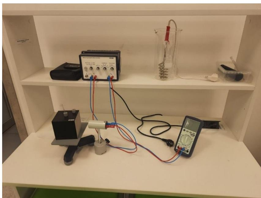
Рисунок 10 – Установка «Лучеиспускаемость горячих тел (куб Лесли)»
