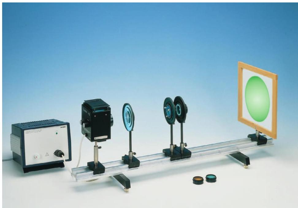
Рисунок 6 – «Установка по получению колец Ньютона»
