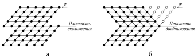
Рис. 1.71. Пластическая деформация скольжением (а) и двойникованием (б)
