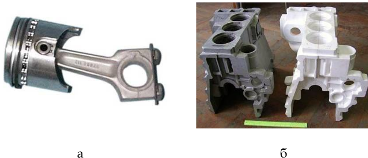
Рис. 2.11. Виды отливок в автомобилестроении: а – поршень с шатуном; б – форма (справа) и отливка (слева) блока цилиндров
