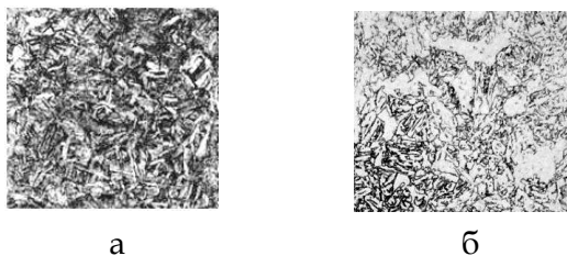
Рис. 1.8. Бейнит игольчатый (а) и зернистый (б)
