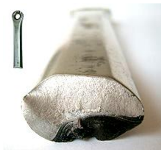
Рис. 1.42. Усталостный излом (а – схема) и вид у шатуна из алюминиевого сплава (б) – темная зона – усталостное разрушение, светлая зона – область хрупкого излома
