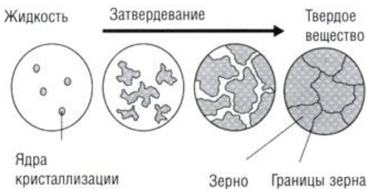
Рис. 1.38. Процесс кристаллизации (твердения) металла
