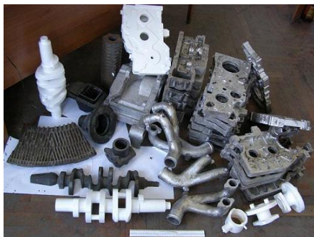
Рис. 2.24. Пенополистироловые модели (белого цвета) и отливки (темного цвета) деталей двигателя автомобиля
