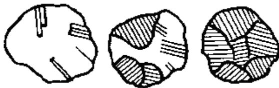
Рис. 1.67. Механизм превращения аустенита в перлит
