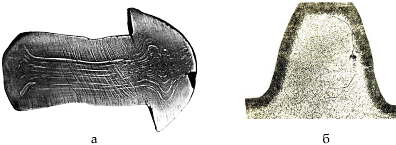
Рис. 1.87. Макроструктура поковки (а) и зуба шестерни после ТВЧ-закалки (б): темные участки у зуба шестерни закаленный слой
