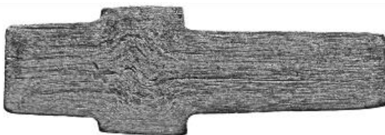
Рис. 1.52. Волокнистое строение макроструктуры поковки вала
