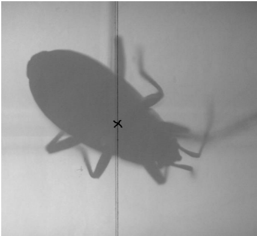
Фото 2 – Проекция клопа-солдатика, вывешенного на оси вращения в проекционном аппарате. Центр тяжести клопа лежит в точке пересечения продольной оси тела и волосяного отвеса (обозначен крестиком)
