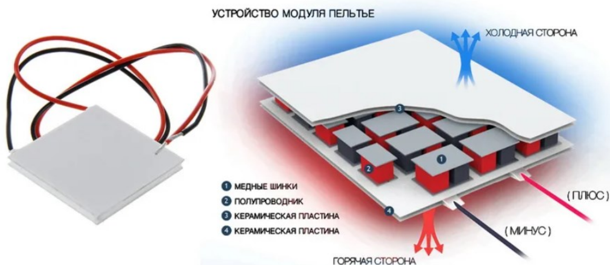
Рисунок 59. Устройство модульного элемента Пельтье
