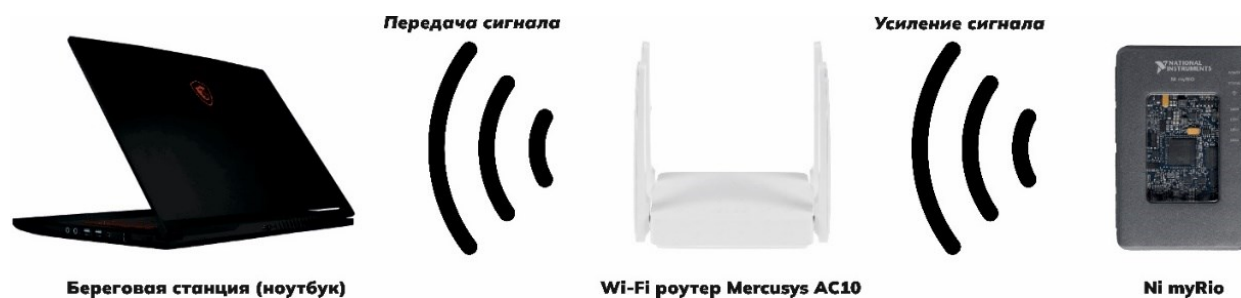
Рисунок 51. Схема организации сети между одноплатным компьютером лодки и береговой станцией
