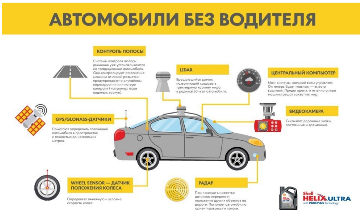
Рисунок 46. Схема устройства автономных транспортных средств
