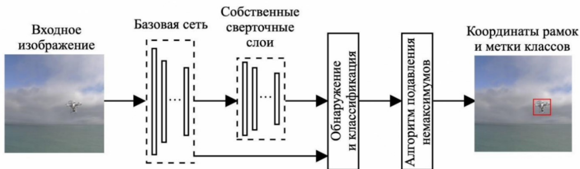
Рисунок 23. Принцип работы модели SSD
