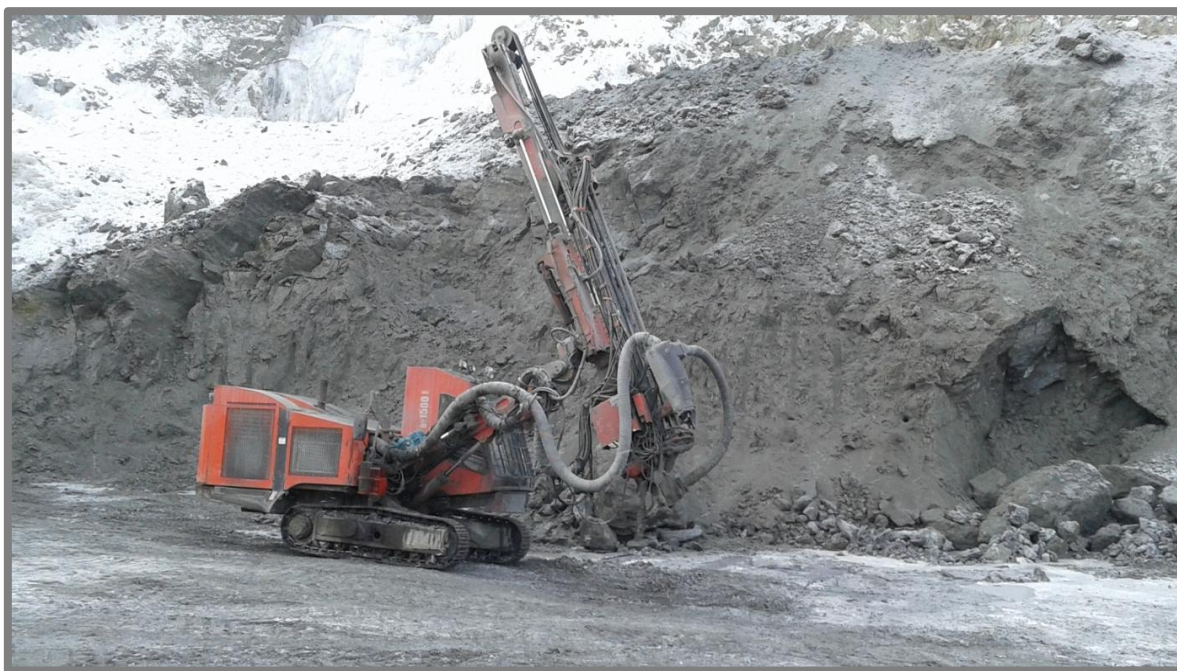
Рис. 4 Буровой станок фирмы At-lasCopco DM45HP (фото автора, 2017 г.)
