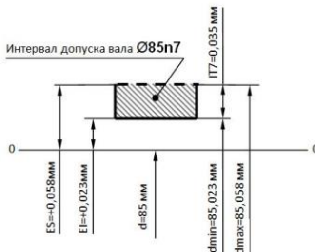
Рисунок 29. Схема расположения интервала допуска вала \varnothing 85n7
