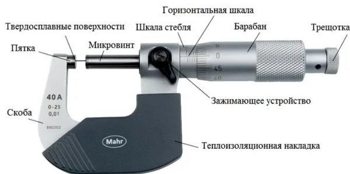
Рисунок 5. Микрометр гладкий
