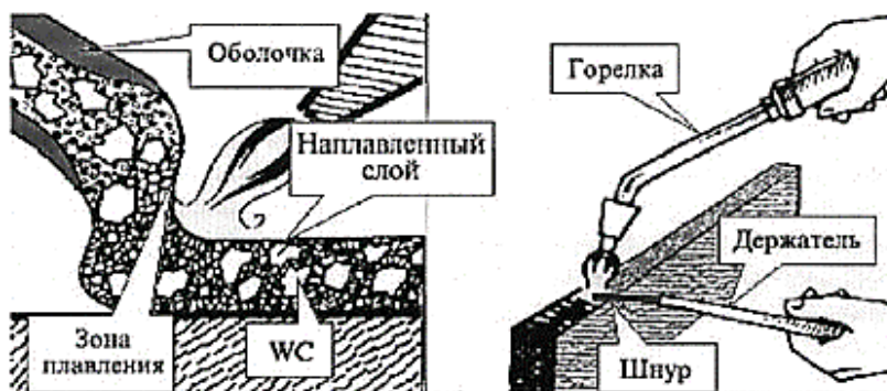
Рис. 2.4 – Технология ручной газопламенной наплавки шнурового материала «Сфекорд-НР» [10]
