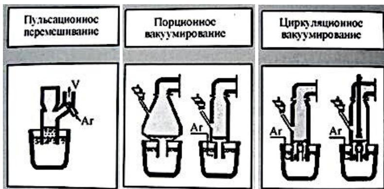
Рисунок 2.11 – Способы вакуумирования стали в вакуум-камере [35]
