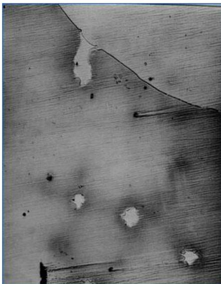
Рисунок 1.21 – Включения фосфидной эвтектики на границе зерна и в зерне [23]
