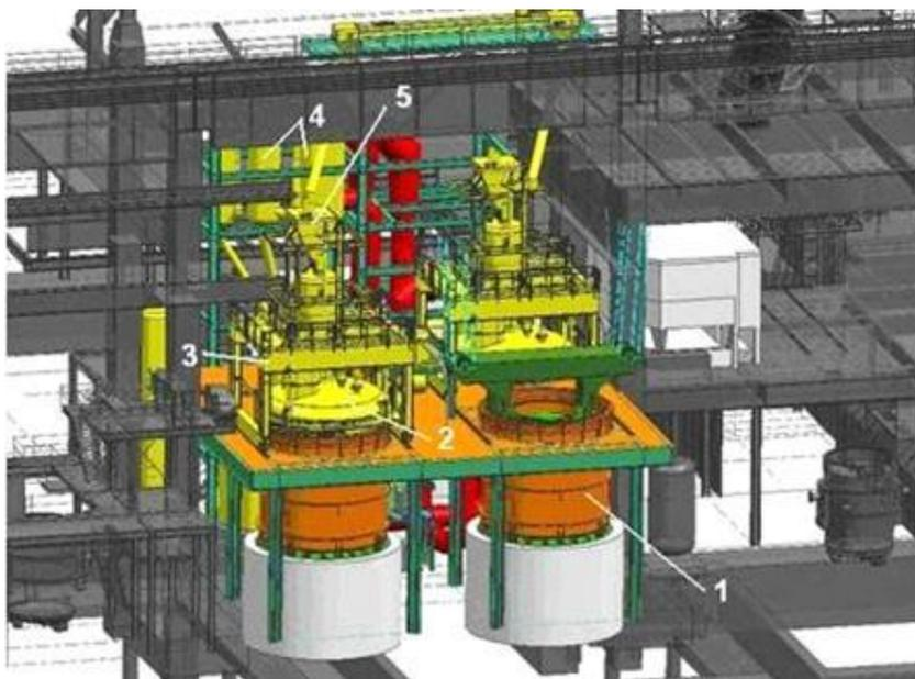
Рисунок 2.16 – Двухпозиционный камерный вакууматор фирмы *SIEMENS-VAI* [35]:
