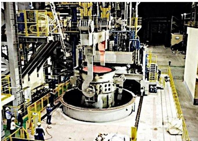
Рисунок 2.15 – Вакууматор *VD-VOD* [41]
