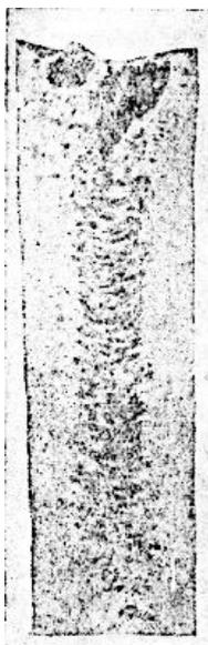
На рисунке 1.4 представлен разрез слитка, протравленный серной кислотой. Сердцевина слитка сильно разъедена реактивом, что объясняется большим количеством в её составе НВ серы, фосфора, углерода и газов.
