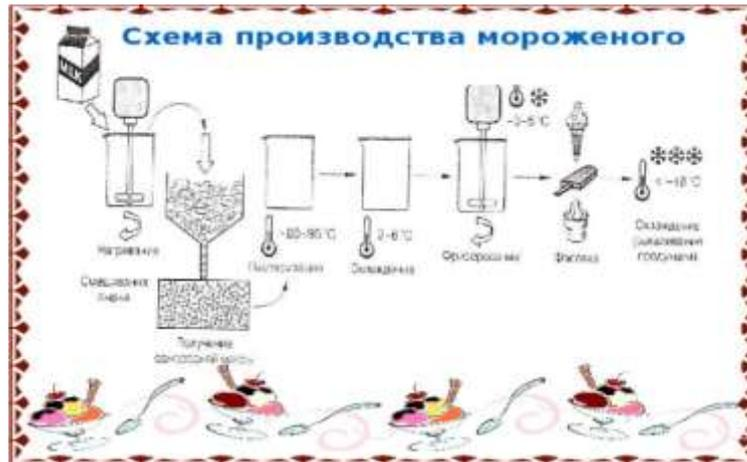
Рис 2. Схема производства мороженого
