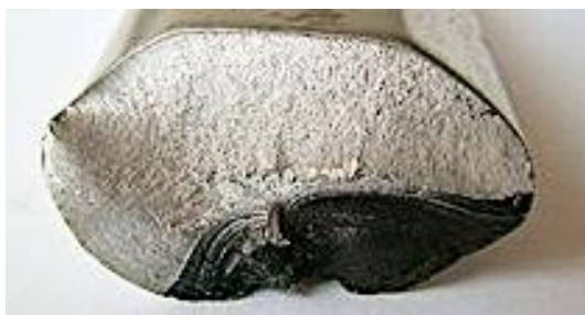
Рис. 1.1 – Характерный усталостный излом [19]
