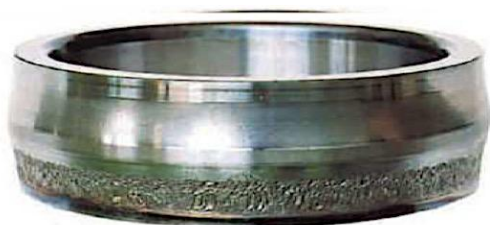
Рисунок 1.8 – Следы фрикционно-контактной усталости внутреннего кольца подшипника скольжения
