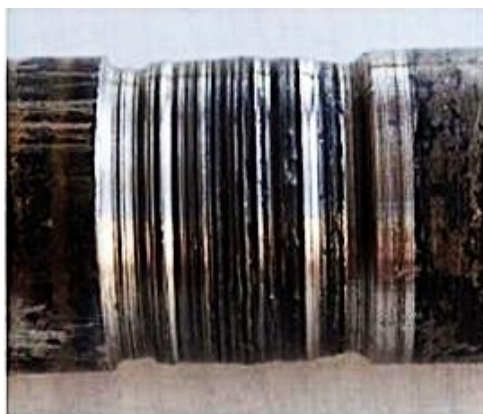
Рисунок 1.6 – Абразивный износ вала [25]
