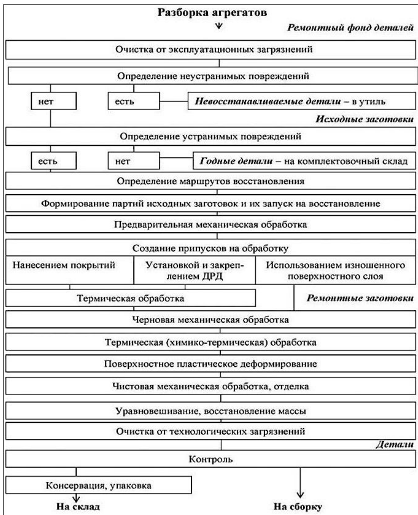
Рисунок 2.1 – Схема технологического процесса восстановления детали [33]
