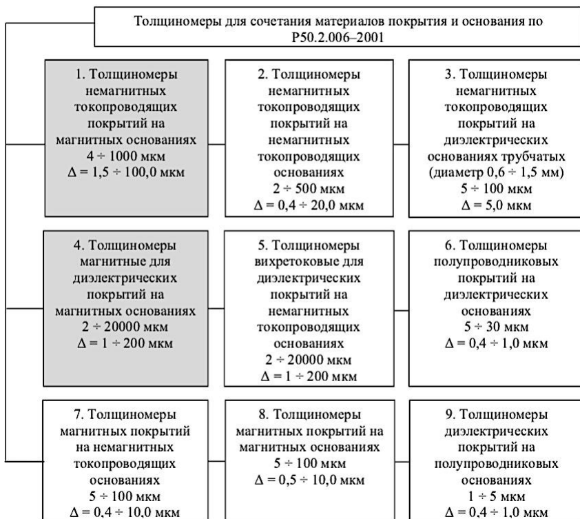
Рис. 4.1 – Рабочие средства измерений по поверочной схеме
