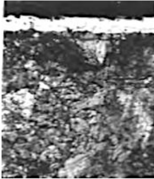
Рис. 3.24 – Микроструктура хромированного слоя (x 200) [74]
