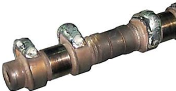
Рис. 2.5 – Газопламенное напыление вершин кулачков стального распределительного вала [12]
