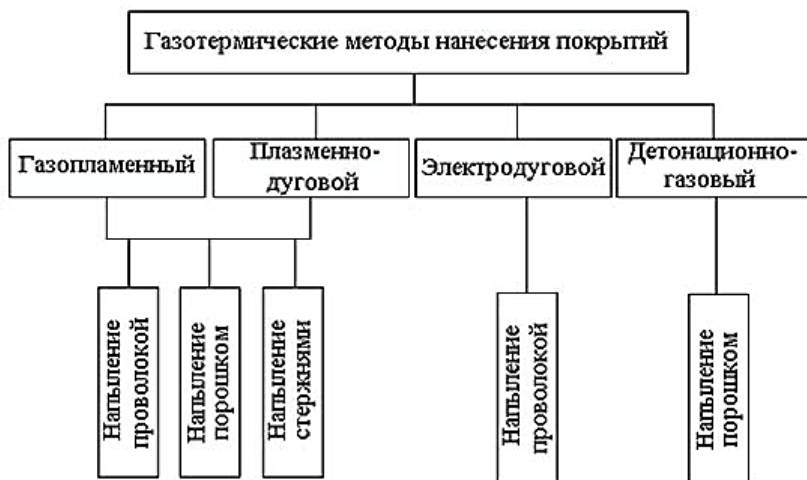
Рис. 2.1 – Классификация способов газотермического напыления по форме напыляемого материала
