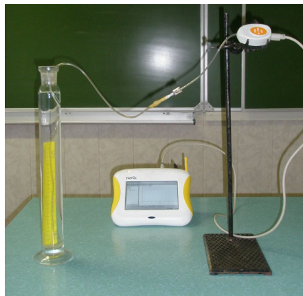
Рисунок 13 — Схема и фото опыта по исследованию закономерностей гидростатического давления
