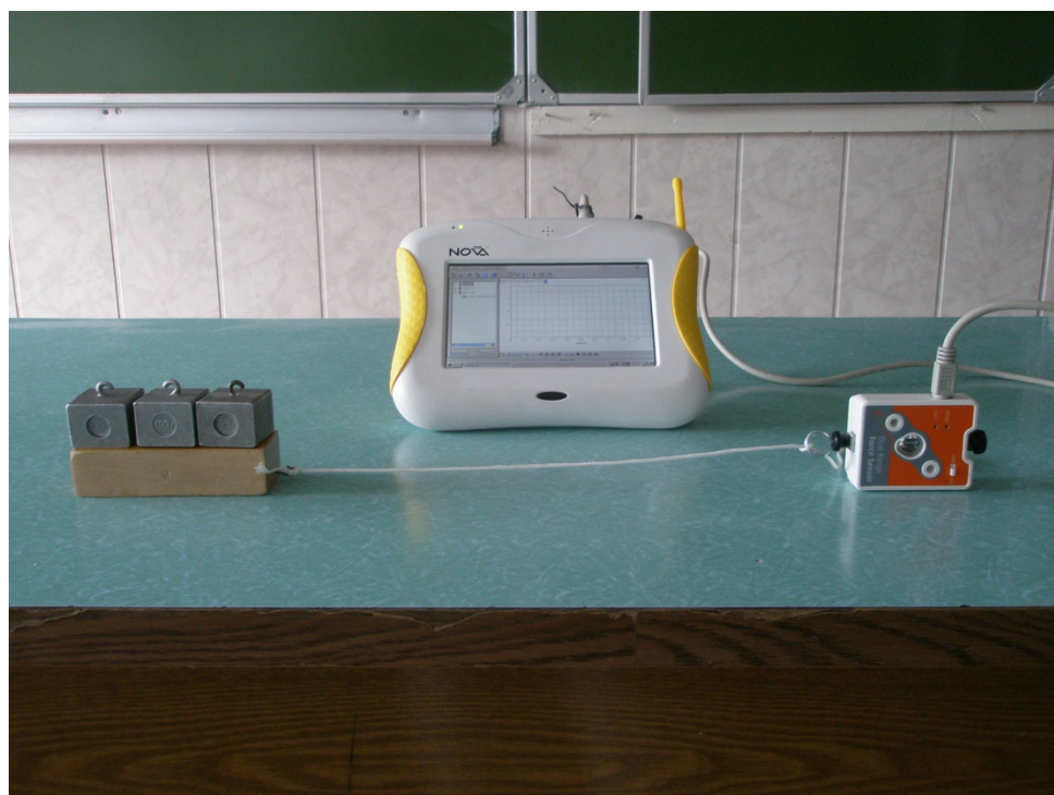
Рисунок 11 — Фото опыта по измерению коэффициента трения с помощью цифровой лаборатории Архимед
