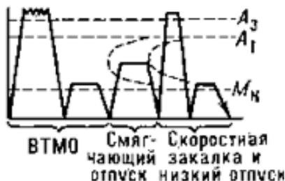
Рис. 4.9 – Схема проведения разновидностей ТМО конструкционных сталей НВТМУ
