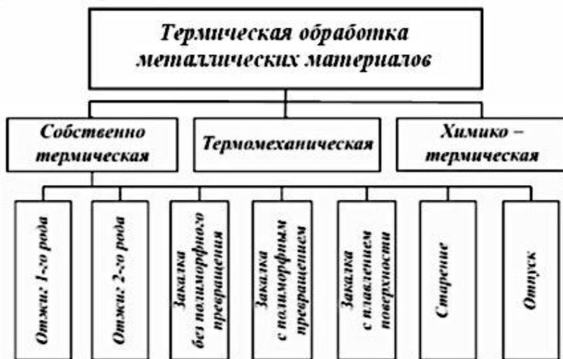
Рис. 1.4 – Виды термообработки стали
