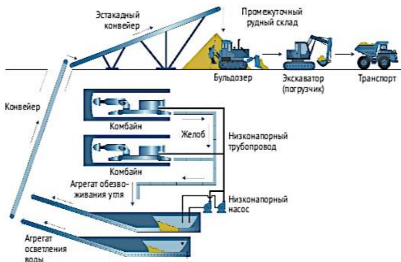
Рисунок 3.2 – Схема технологического процесса добычи подземным способом с использованием в забое самотечно-напорного гидротранспорта [26]
