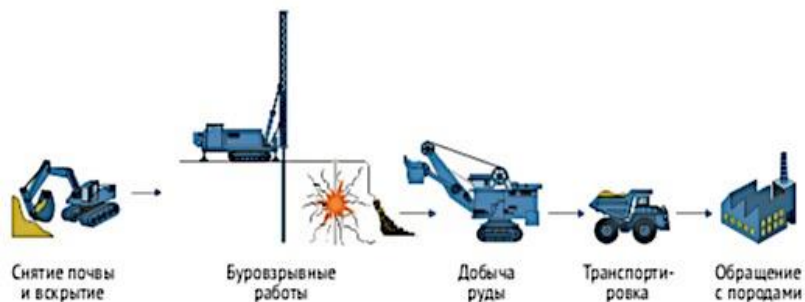
Рисунок 3.1 – Схема технологического процесса добычи алюминиевого сырья открытым способом [26]
