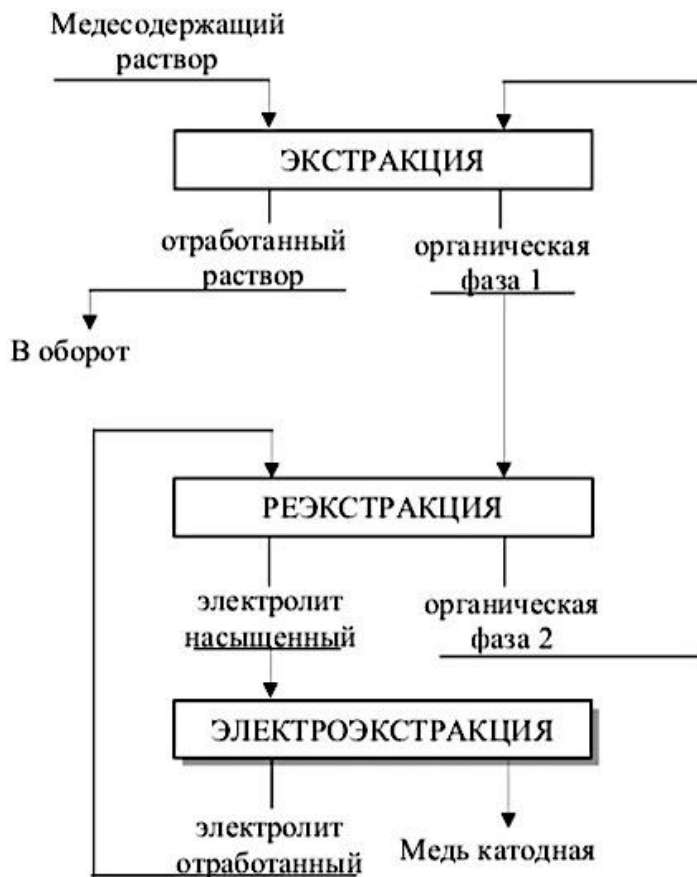
Рисунок 3.26 – Технологическая схема электроэкстракции меди из растворов
