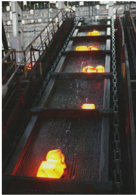
Рис. 3.11. Вид цепного скребкового конвейера с обрезками от головной и донной частей слитка
