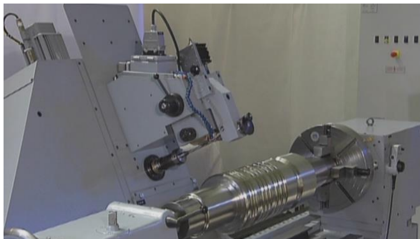
Рис. 4.62. Фрезерование чистовых ручьёв
