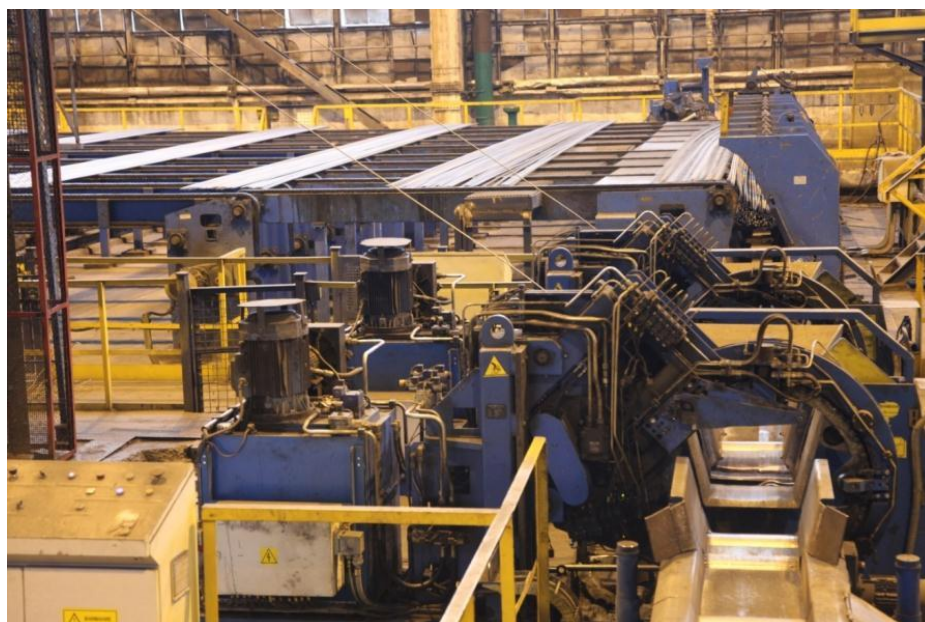
Рис. 4.92. Автоматическая увязка пакетов готового проката
