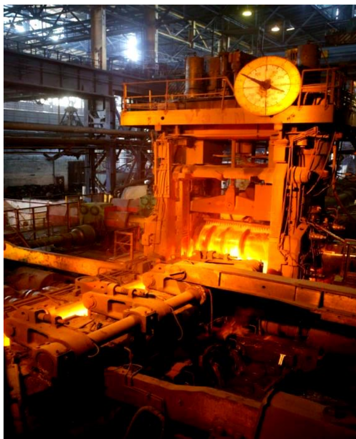
Рис. 3.9. Внешний вид клетки блюминга 1250 ПАО «АрселорМиталлКриворожсталь»
