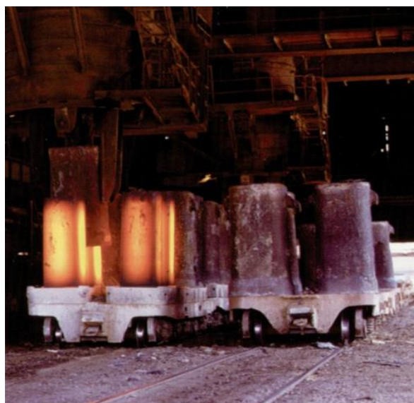
Рис. 3.2. Стрипперное отделение: снятие изложниц со слитков кипящей стали
