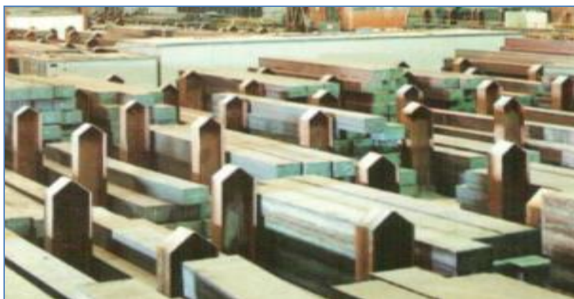
Рис. 3.32. Вид стеллажей для складирования пакетов непрерывнолитых блюмов (в пакете 3 шт.)
