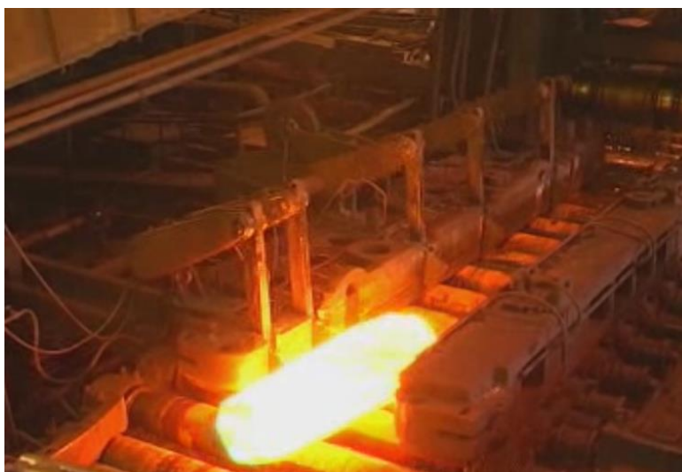
Рис. 3.16. Кантовка слитка на приемном рольганге блюминга
