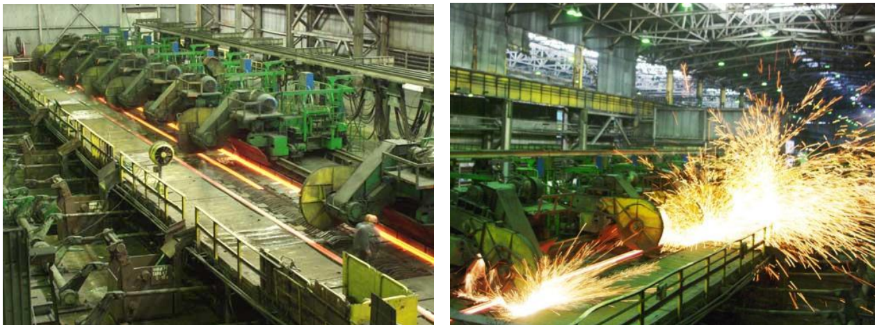
Рис. 4.26. Порезка раската на пилах горячей резки
