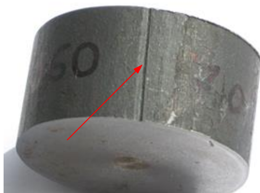
Рис. 2.12. Вид дефекта «подрез» на поверхности круглого проката
