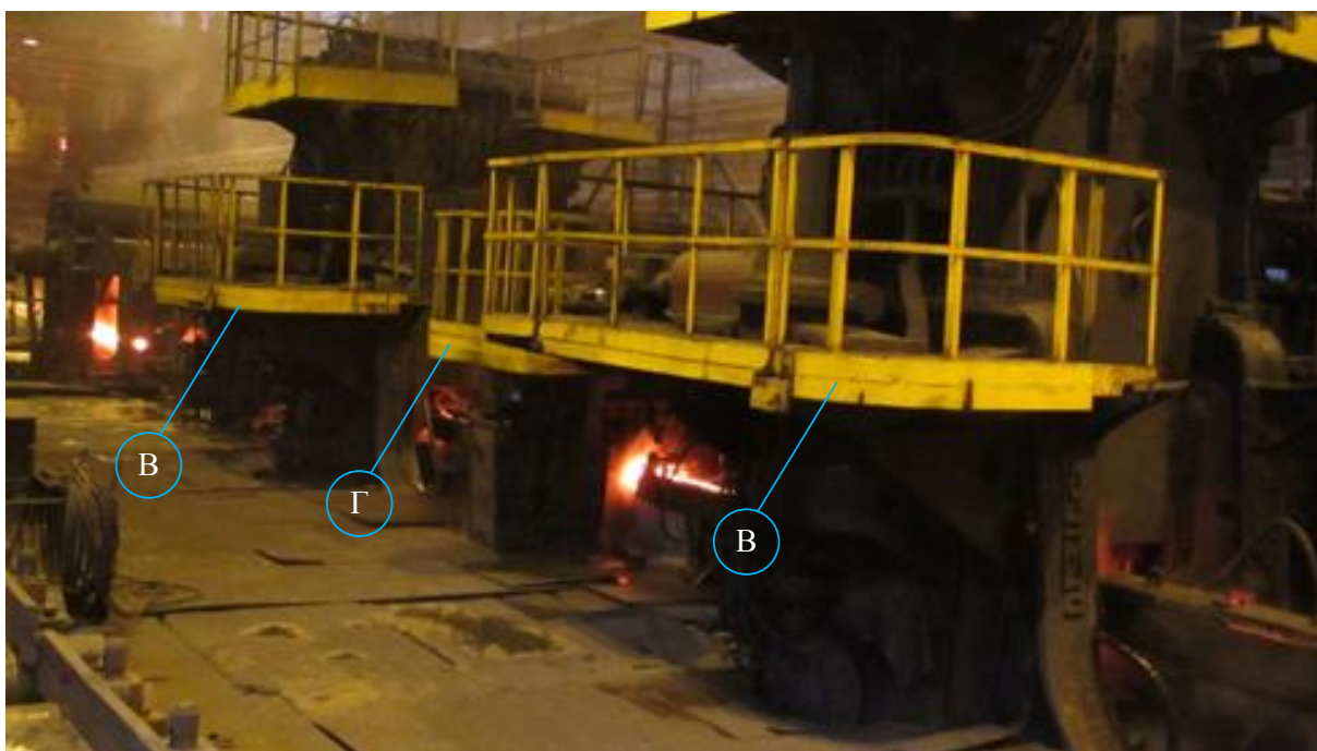
Рис. 3.21. Вид клеток группы 500 в линии стана (по мере удаления: вертикальная – горизонтальная – вертикальная соответственно)
