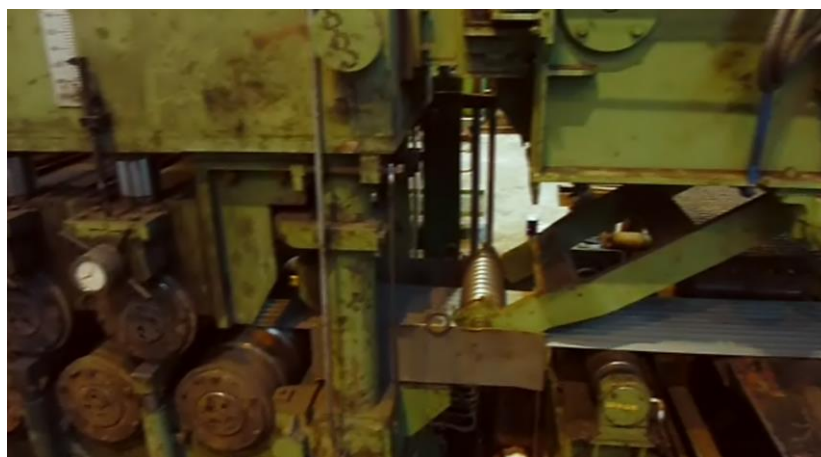
Рис. 4.55. Многоручьевая правильная машина
