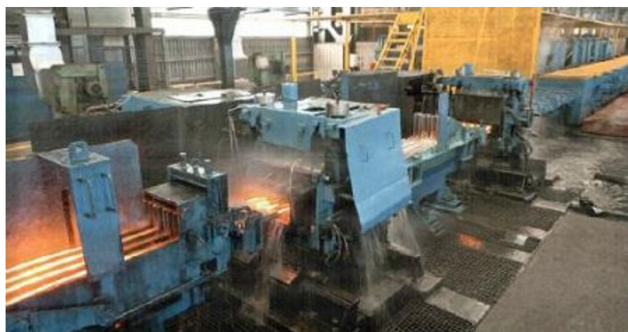
Рис. 4.66. Схема многониточной прокатки (а) и внешний вид клетки, прокатывающей в четыре нитки (б)
