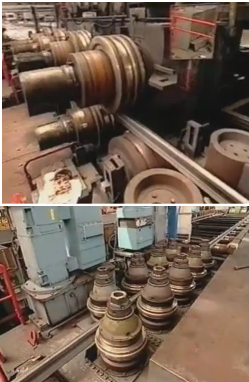
Рис. 4.20. Правка рельсов в роликотправильной машине
