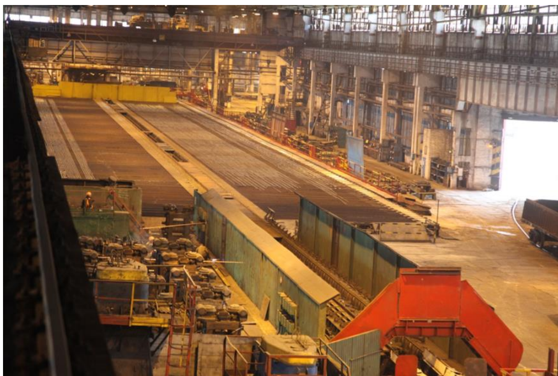
Рис. 4.90. Двухсторонний речный холодильник с транспортным рольгангом в центре
