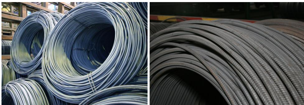
Рис. 4.72. Вид мотков готового проката: а – гладкий круг, катанка; б – арматурный прокат
