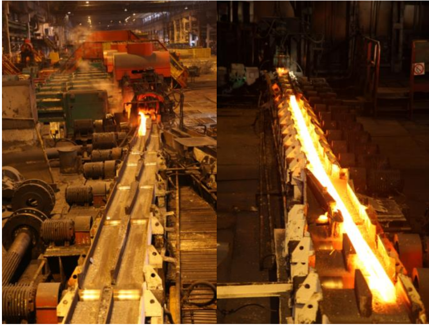
Рис. 4.87. Транспортировка заготовки из печи по соединительному рольгангу к черновой группе клетей
