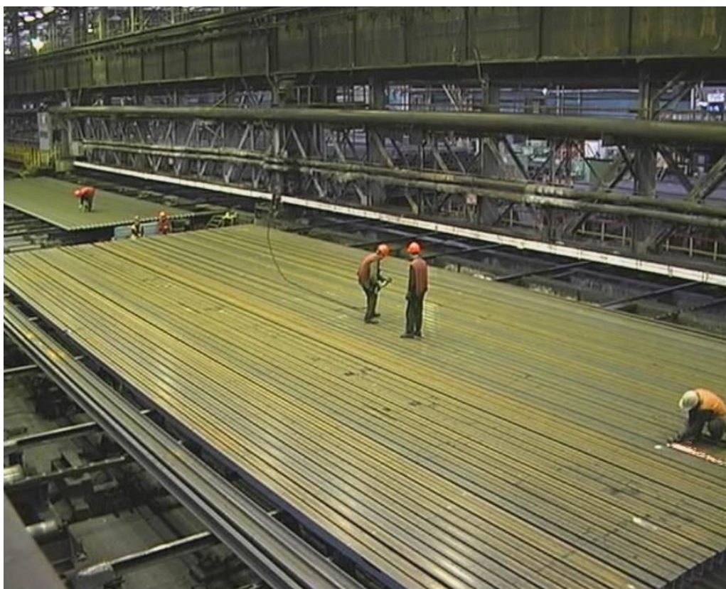
Рис. 4.22. Осмотр и зачистка дефектов на поверхности рельсов
