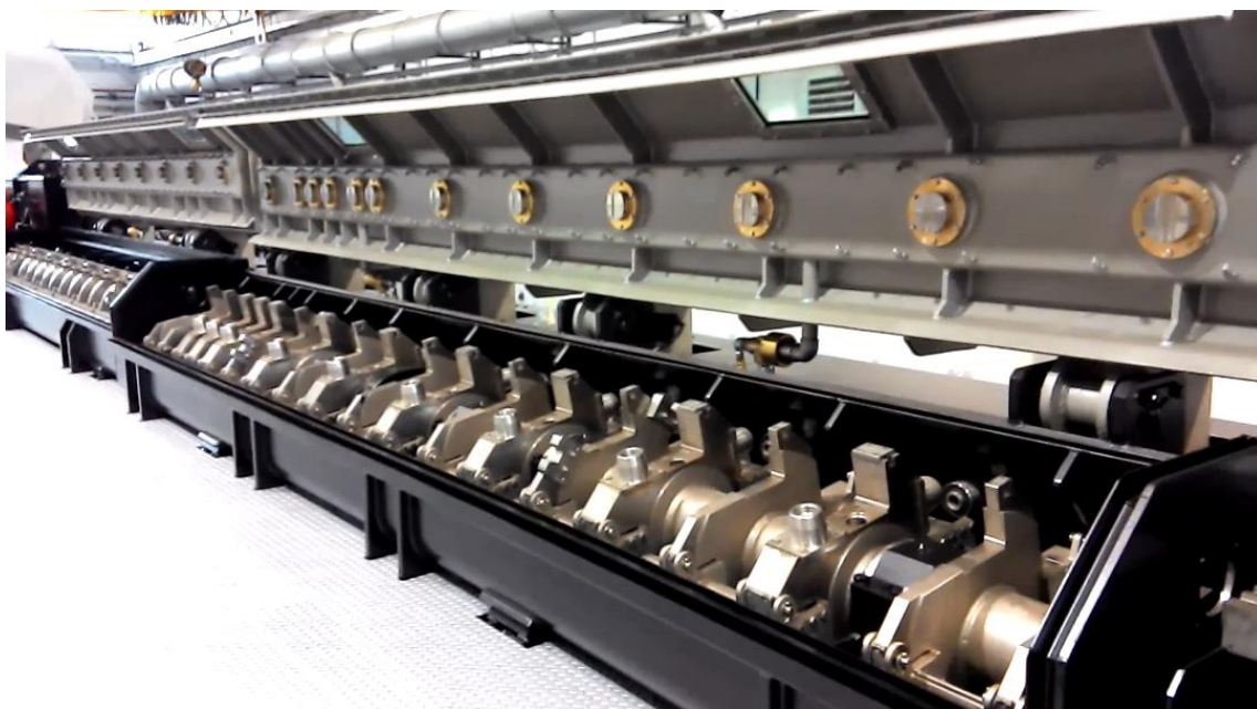
Рис. 4.83. Внешний вид секции регулируемого охлаждения DSC
