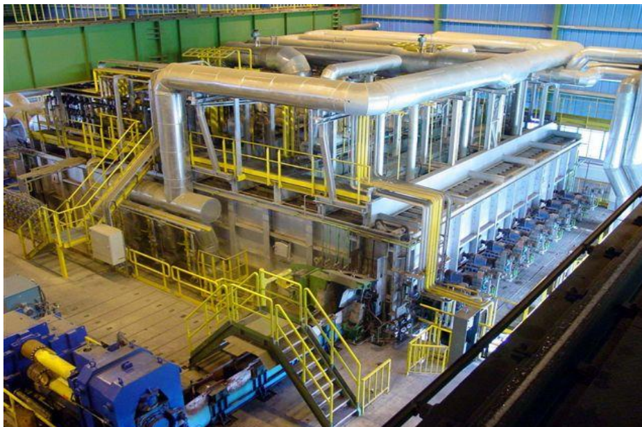
Рис. 4.43. Внешний вид печи с шагающими балками
