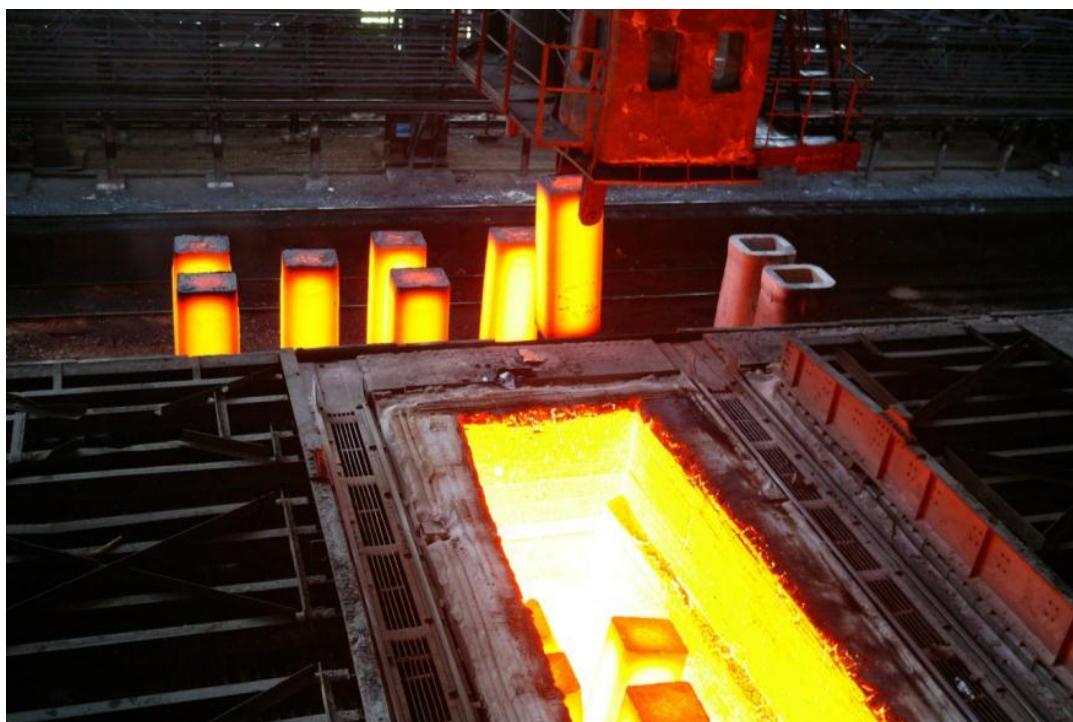
Рис. 3.4. Посадка слитков в отделении нагревательных колодцев с железнодорожной платформы
