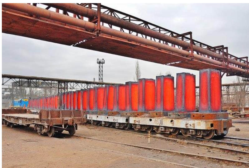
Рис. 3.3. Транспортировка слитков из стрипперного отделения в отделение нагревательных колодцев
