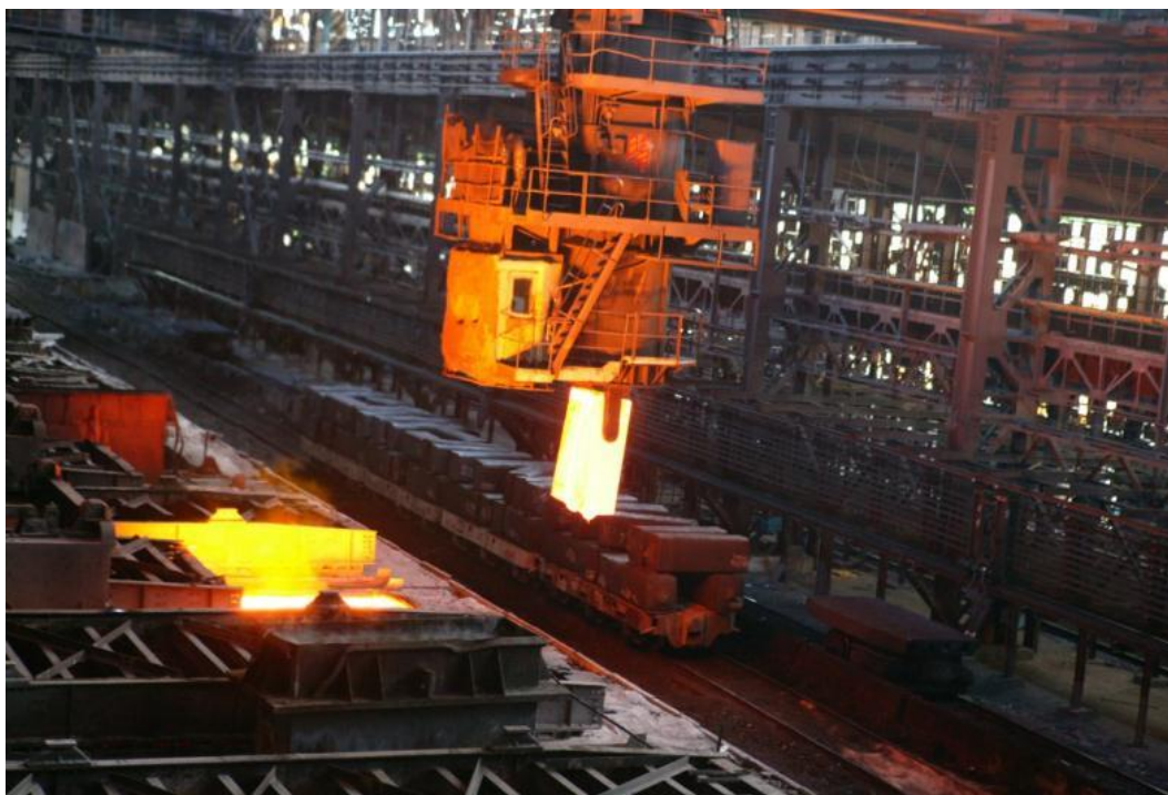
Рис. 3.6. Вид ячейки нагревательных колодцев с открытой крышкой в момент выгрузки слитка
