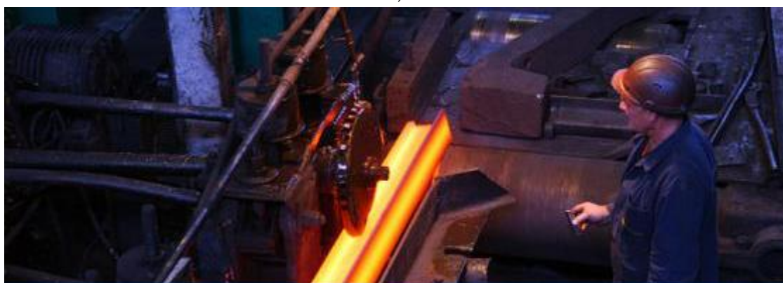
Рис. 4.17. Внешний вид штампера на поверхности рельса (а, слева), штампельного диска (а, справа) и процесс прохода рельса через штампельную машину (б)
