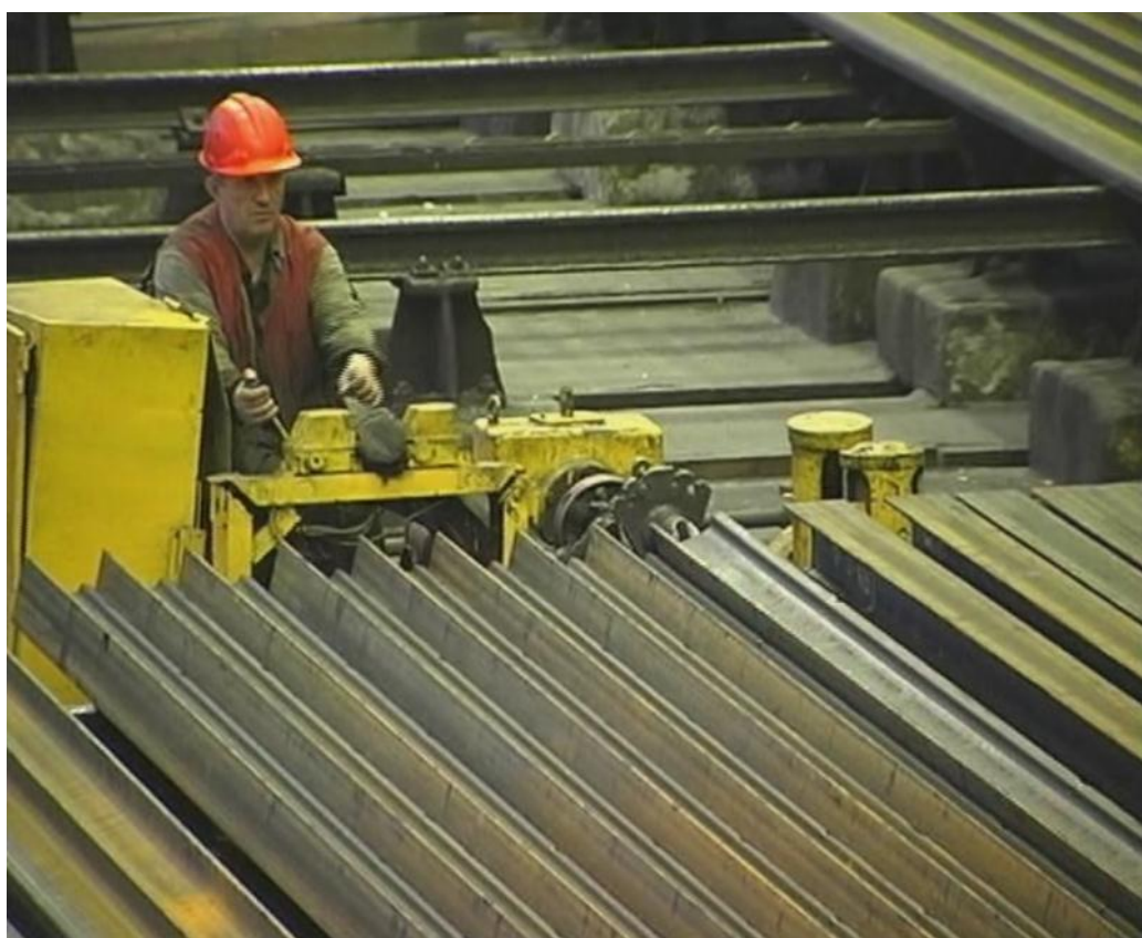
Рис. 4.23. Кантовка рельсов на отделочном стеллаже
