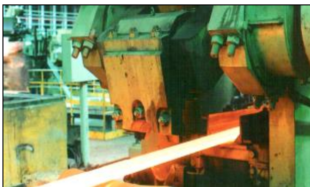
Рис. 3.42. Внешний вид четырехкривошипных летучих ножниц
