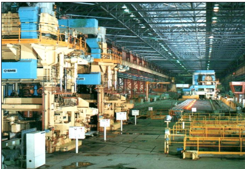
Рис. 3.39. Две линии непрерывной прокатки (I и II), соединенные решеткой для поперечной транспортировки проката
