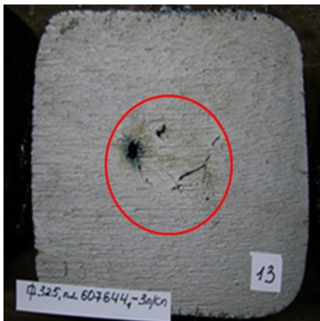
Рис. 4.12. Подушачная рыхлость в сечении горячекатаного бьюма
