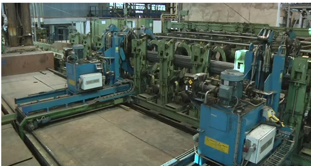
Рис. 4.57. Машина обвязки пакетов
