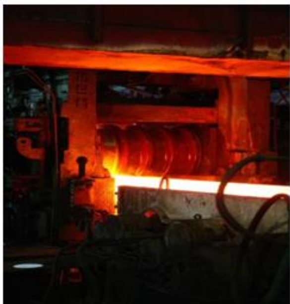
Рис. 3.24. Вид валков 3-й клетки с ящичными калибрами (а) и направляющими проводками (б)
