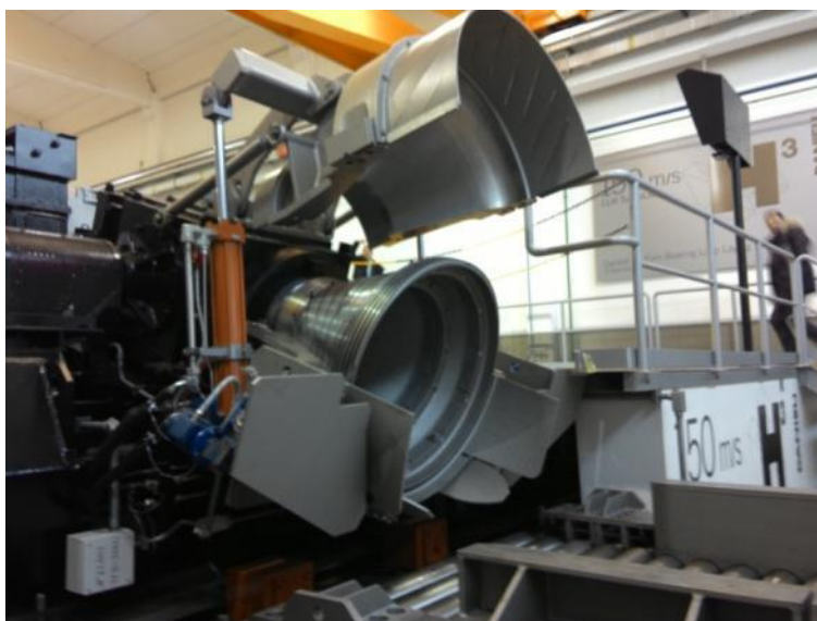
Рис. 4.84. Внешний вид виткоукладчика катанки конструкции Danieli
