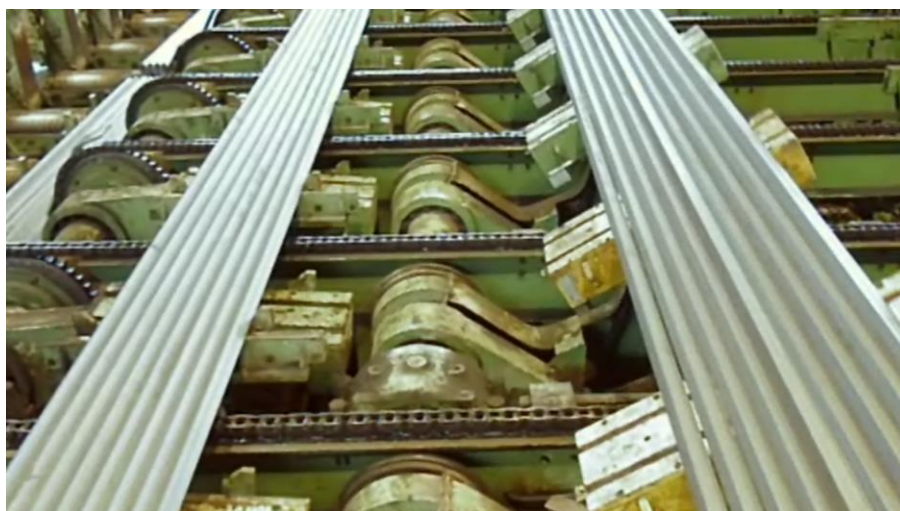
Рис. 4.58. Магнитные поворотные (кантующие) устройства
