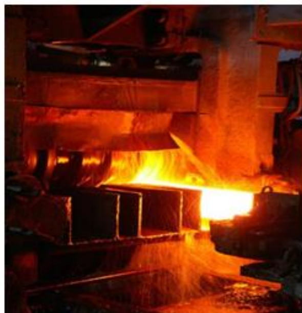
Рис. 3.24. Вид валков 3-й клетки с ящичными калибрами (а) и направляющими проводками (б)
