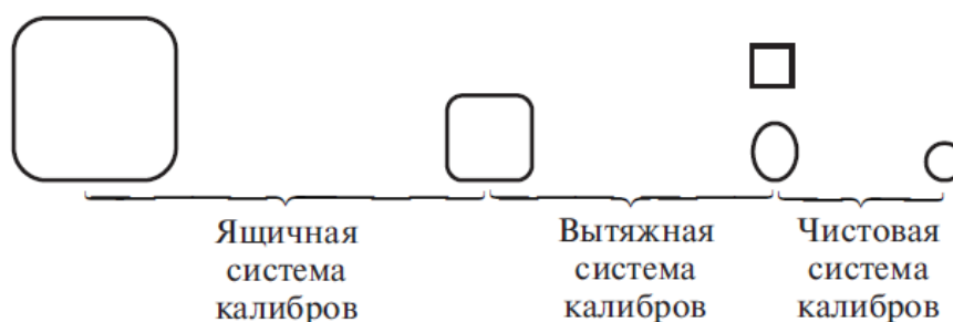
Рис. 4.94. Общая схема прокатки простых профилей [1]
