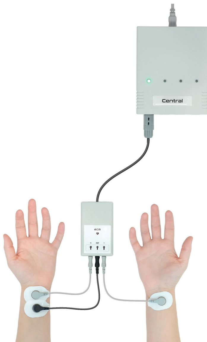
Рисунок 24 – Подключение сенсора для измерения ЭКГ в I отведении (Бережной Д.С., 2021)
