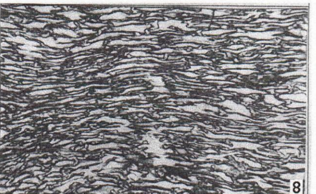
Рис. 5. Фотографии микроструктур тесла (1—2) и ножей (3—8) Увел. 120. 1—2 — ан. 432 (1 — срез обуха, 2 — лезвия); 3 — ан. 441; 4 — ан. 442; 5 — ан. 427; 6 — ан. 414 (срез черенка); 7 — ан. 418; 8 — ан. 434
