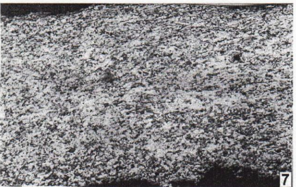
Рис. 5. Фотографии микроструктур тесла (1—2) и ножей (3—8) Увел. 120. 1—2 — ан. 432 (1 — срез обуха, 2 — лезвия); 3 — ан. 441; 4 — ан. 442; 5 — ан. 427; 6 — ан. 414 (срез черенка); 7 — ан. 418; 8 — ан. 434
