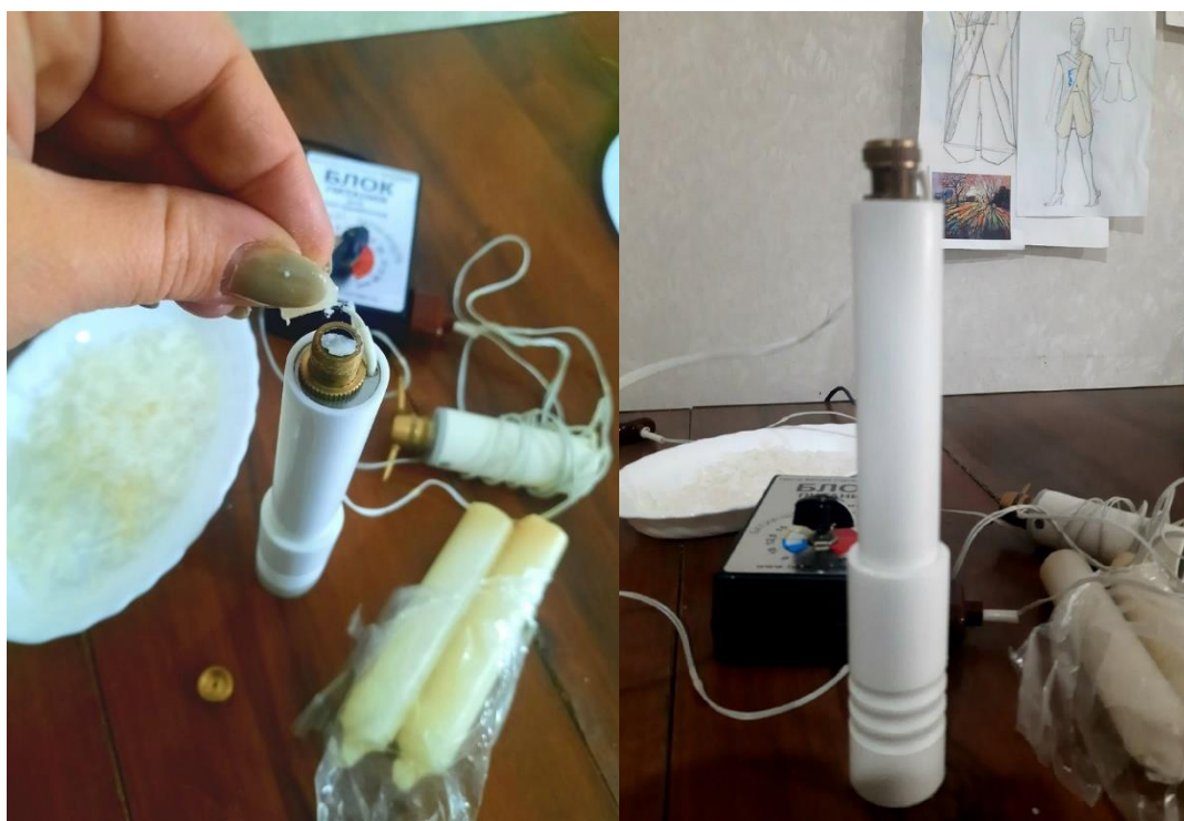
Рисунок 23 – Заполнение резервуара воском
