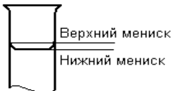
Рис. 3 Вид поверхности смазывающей жидкости в стеклянной трубке
