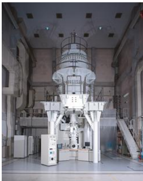
Рис. 4.1. Просвечивающий электронный микроскоп высокого разрешения JEOL JEM-ARM 1300
