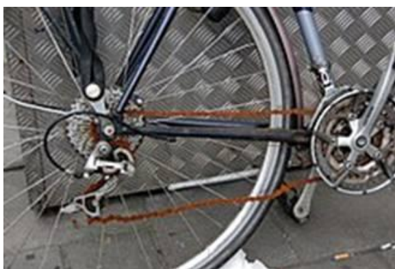
Рисунок 5.1 – Коррозия велосипедной цепи
