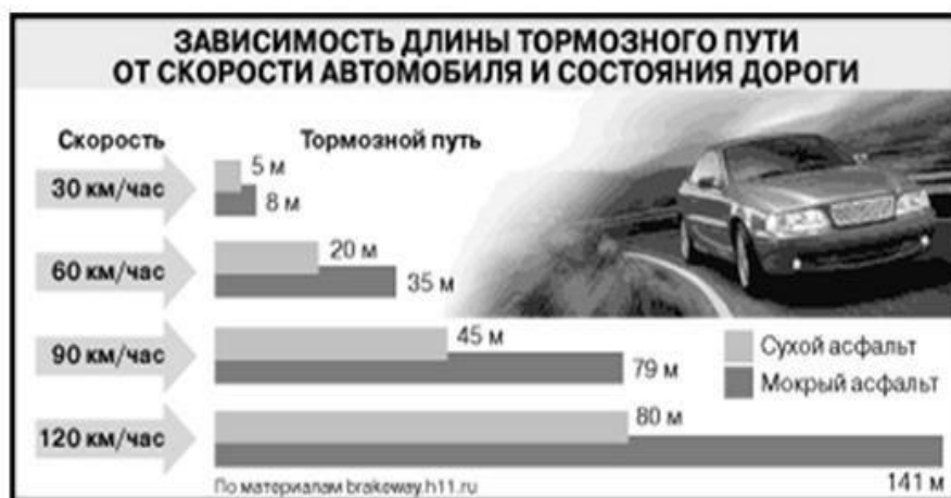
Рисунок 19 – Зависимость длины тормозного пути от скорости автомобиля и состояния дороги
