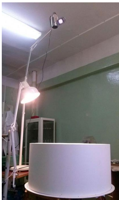
Рис. 10. Общий вид установки для фиксации поведенческих реакций – активности экспериментальных животных в тесте «Открытое поле»
