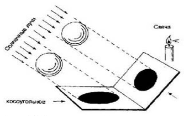
Рисунок №11- Иллюстрация к заданию. Параллельное проецирование.
