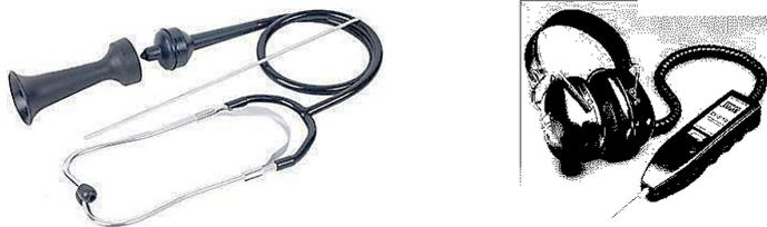
Рис. 1.10. Механический и электронный стетоскопы
