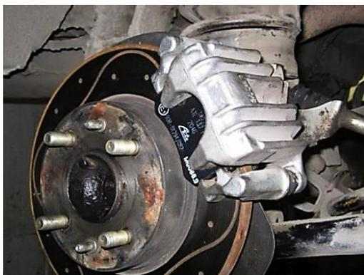
Рис. 2.36. Дисковый тормозной механизм передних колес
