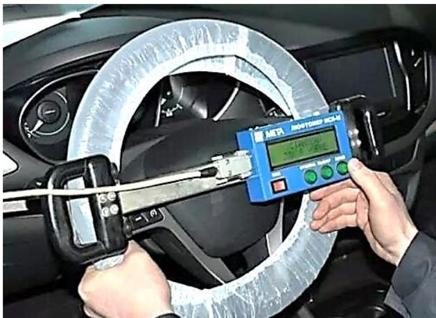
Рис. 2.34. Проверка люфта руля с использованием прибора ИСЛ-М
