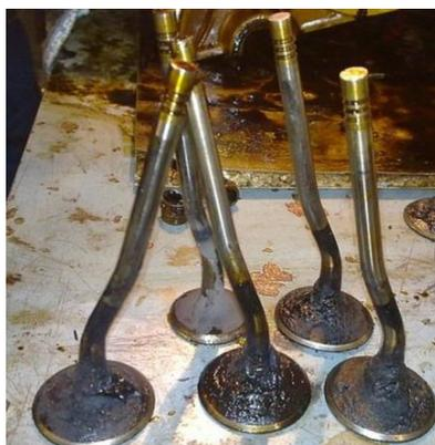
Рис. 2.20. Повреждения клапанов двигателя при обрыве цепи ГРМ
