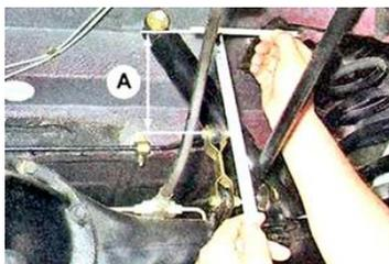
Рис. 2.50. Схема установки расстояния А для регулировки положения регулятора давления тормозов
