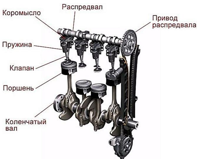
Рис. 2.16. Конструкция газораспределительного механизма
