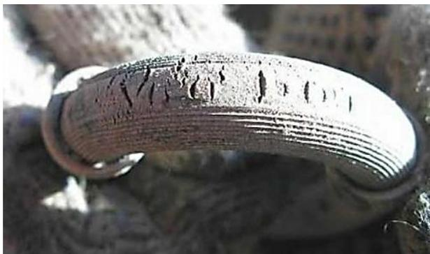
Рис. 2.40. Трещины на тормозном шланге
