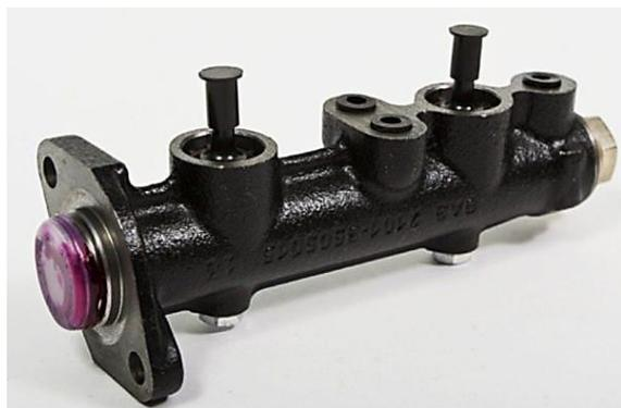
Рис. 2.37. Главный тормозной цилиндр
