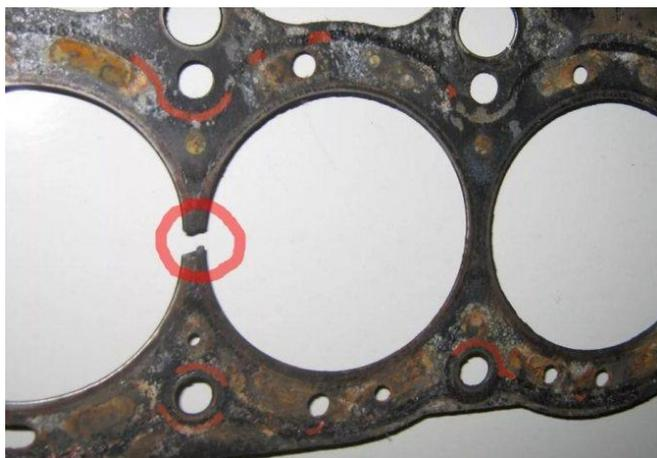
Рис. 2.3. Пробой прокладки ГБЦ между цилиндрами
