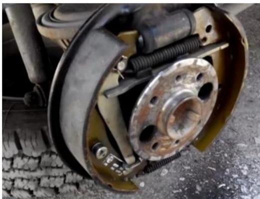
Рис. 2.39 – Барабан с внутренними колодка задних тормозов VAZ-2106
