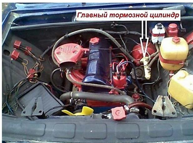
Рис. 2.42. Расположение ГТЦ под капотом автомобиля
