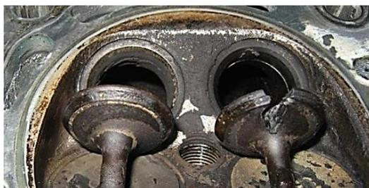
Рис. 2.24. Прогар тарелки клапана механизма ГРМ ДВС
