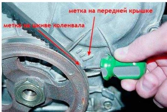
Рис. 2.25. Метки на шкиве коленчатого вала и на передней крышке двигателя
