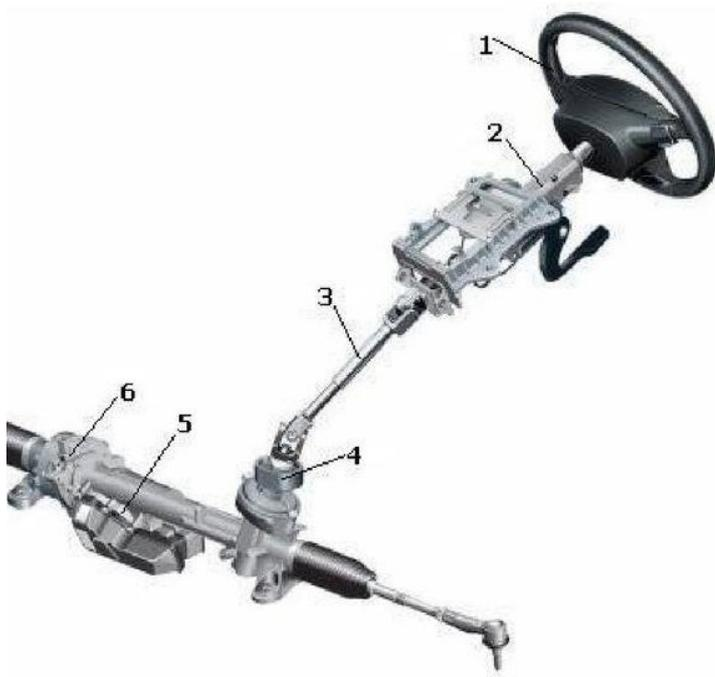
Рисунок 15 – части рулевого управления автомобиля
