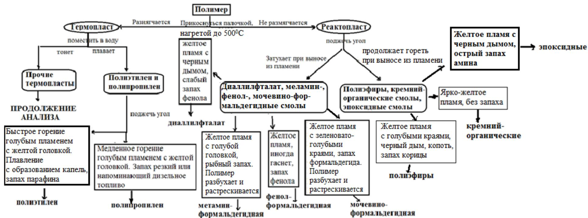
Рисунок 1 – Схема анализа полимера на основе горения [29]
