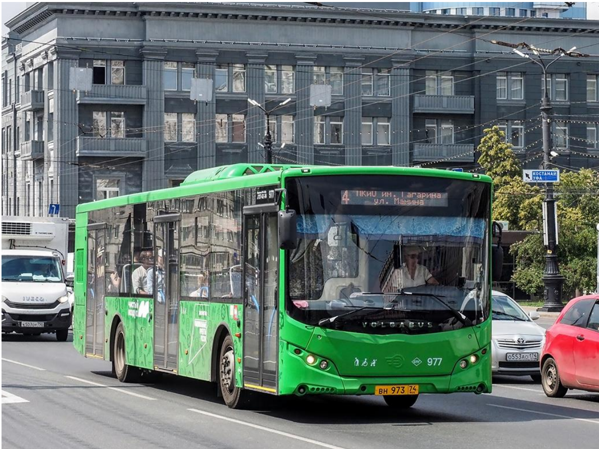
Рисунок 5 – Автобус Volgabus-5270.G2 (LNG), оформленный в едином стиле транспорта Челябинской агломерации (фото – пользователь базы fotobus.msk.ru Fedor45)
