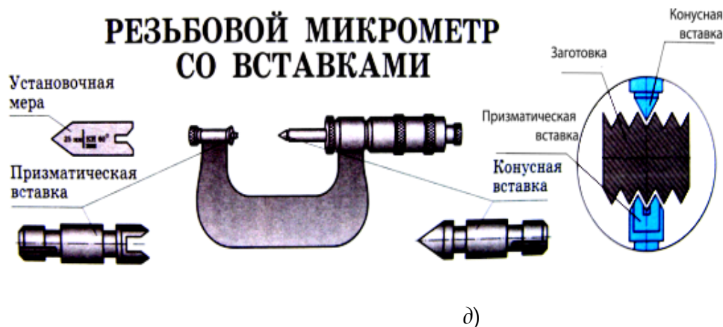
Рис. 1. Резьбовые калибры (а, б) и шаблоны (в), скобы (г), микрометры (д)
