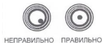
Рисунок 1.2 – Правильное и неправильное положение воздушного пузырька
