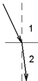
Рисунок 25 – Преломление светового луча на границе раздела фаз
