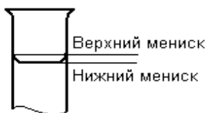
Рисунок 4 – Вид поверхности смачивающей жидкости в стеклянной трубке
