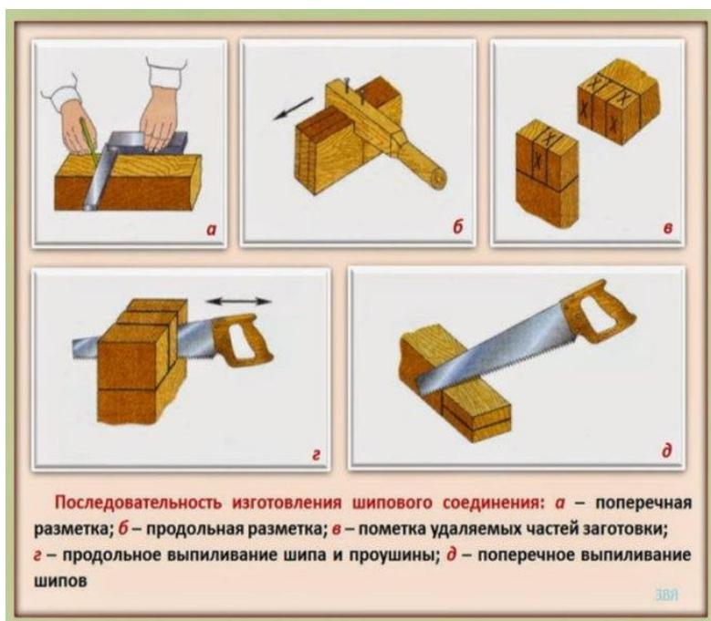
Рис. 12. Последовательность изготовления шипового соединения
