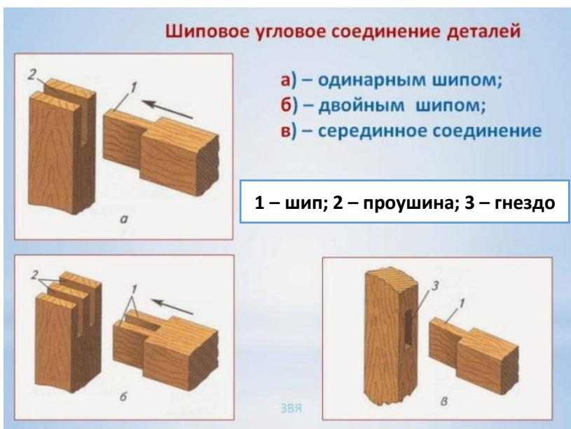
Рис. 11. Шиповое угловое соединение деталей
