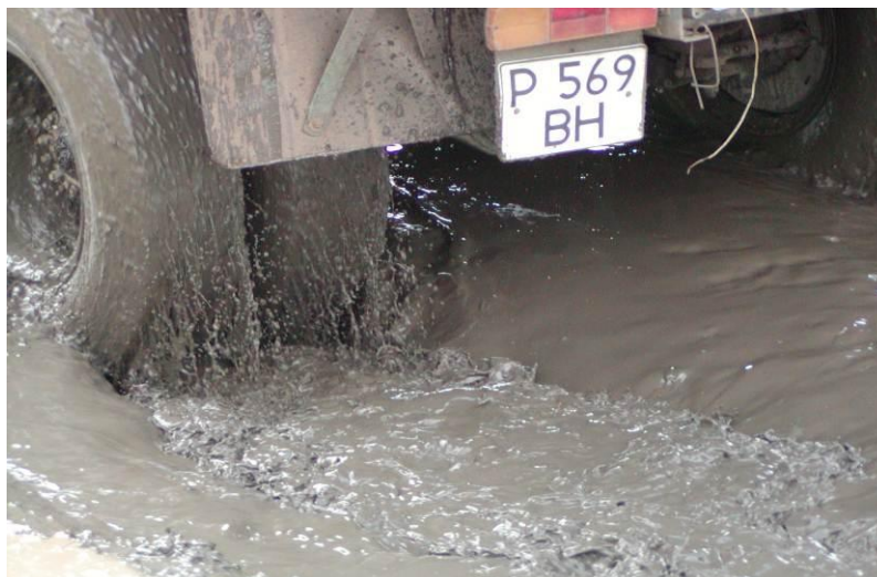
Рис. 2.24. «Засаливание» рисунка автомобильного колеса при буксовании на размытой грунтовой дороге
