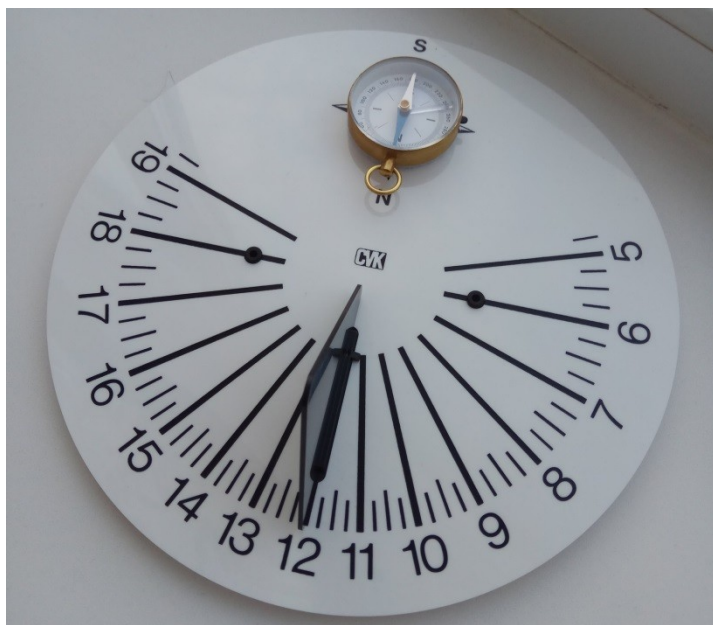
Рисунок 13. Модель солнечных часов из комплекта лабораторного оборудования «Свет и тень»
