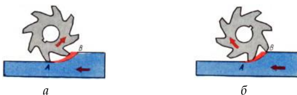
Рис. 2.19 Встречное (а) и попутное (б) фрезерование
