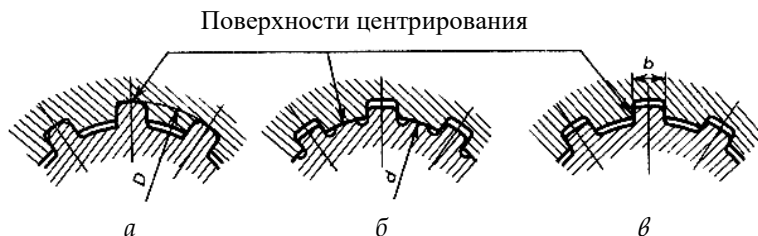
Рис. 1.21 Способы центрирования ступицы на валу: a – по наружному диаметру D ; б – по внутреннему диаметру d ; в – по боковым граням
