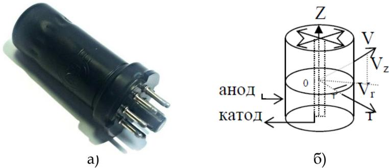
Рис. 49. Внешний вид лампы пентод (а) и проекции вектора скорости в цилиндрической системе координат (б)
