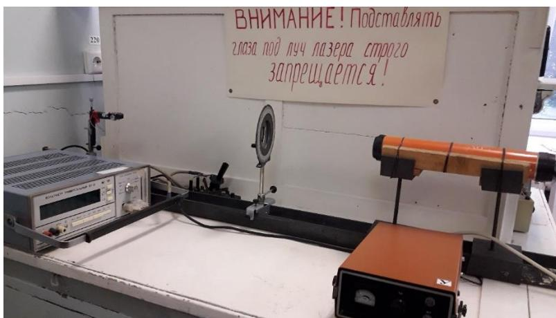
Рис. 102. Экспериментальная установка для изучения дифракции Фраунгофера
