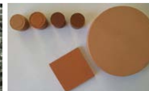
РИСУНОК 3. ОБРАЗЦЫ КЕРАМИЧЕСКИХ МАТЕРИАЛОВ ДЛЯ ИССЛЕДОВАНИЙ ФИЗИКО-МЕХАНИЧЕСКИХ СВОЙСТВ И ТЕПЛОПРОВОДНОСТИ
