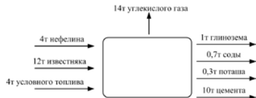
РИСУНОК 2. МАТЕРИАЛЬНЫЙ БАЛАНС ПРОИЗВОДСТВА ГЛИНОЗЕМА ИЗ НЕФЕЛИНА (НЕ УЧТЕН РАСХОД КИСЛОРОДА ВОЗДУХА)
