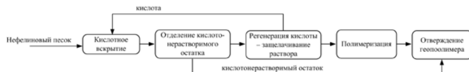
РИСУНОК 5. ПРИНЦИПИАЛЬНАЯ ТЕХНОЛОГИЧЕСКАЯ СХЕМА ПОЛУЧЕНИЯ ГЕОПОЛИМЕРА ИЗ НЕФЕЛИНА
