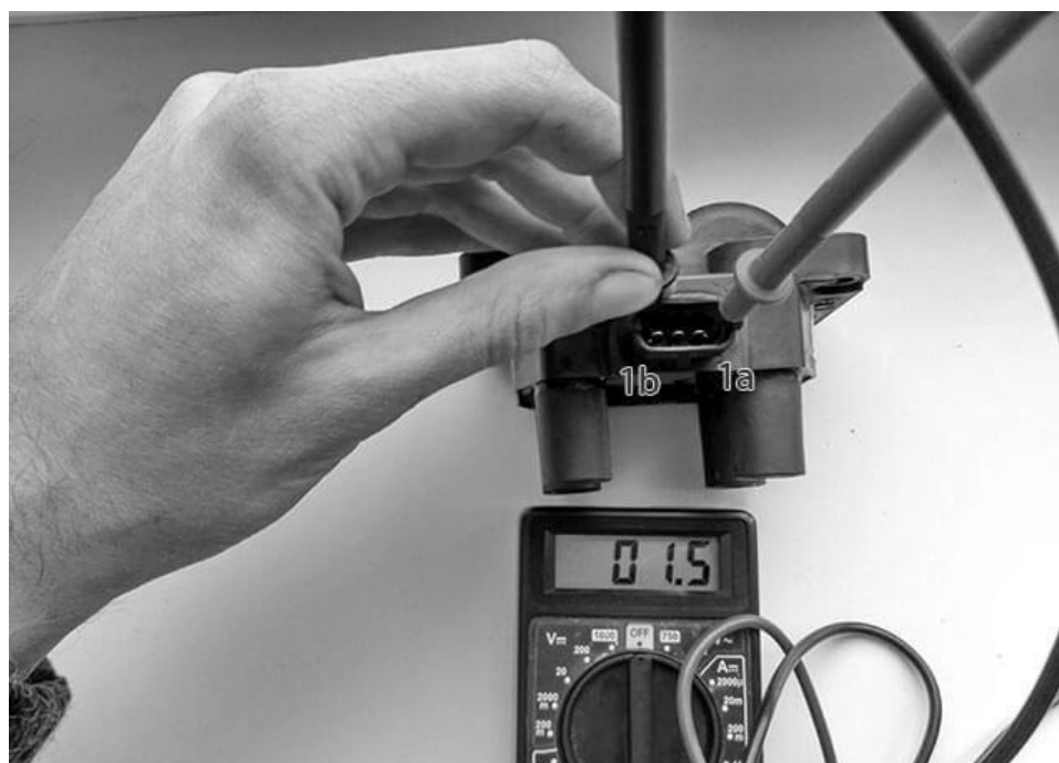
Рис. 137. Проверка первичной обмотки катушки зажигания мультиметром
