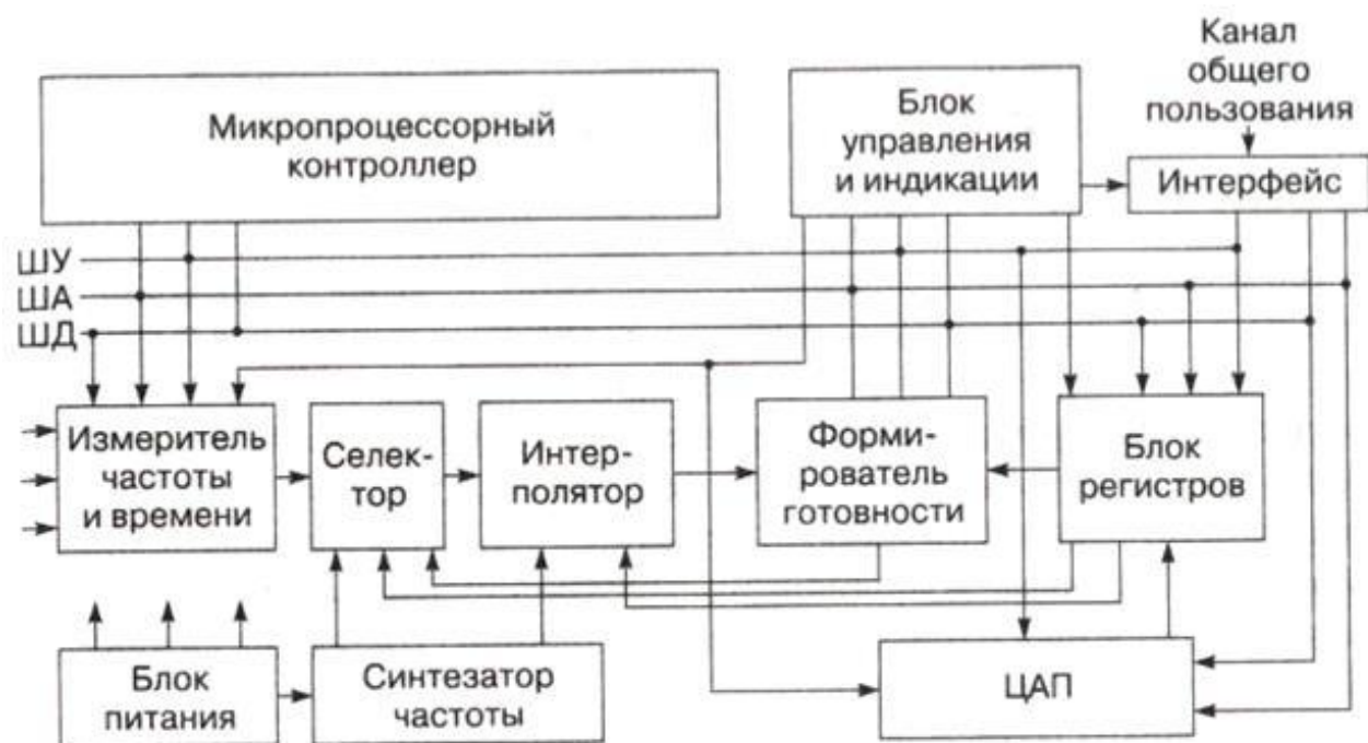
Рис. 83. Структурная схема измерителя частоты сигнала и интервалов времени со встроенным микропроцессором
