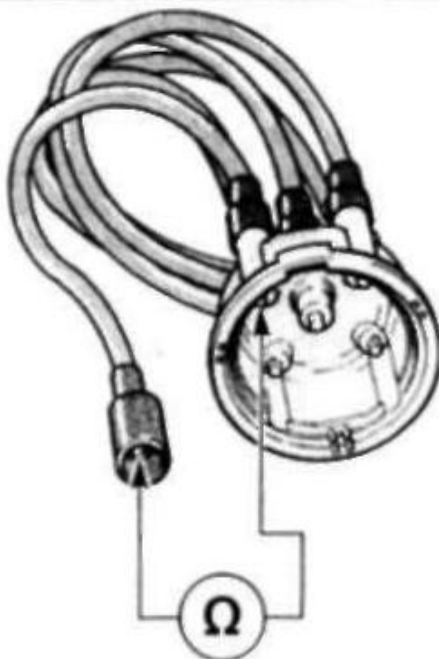
Рис. 141. Проверка распределителя зажигания мультиметром
