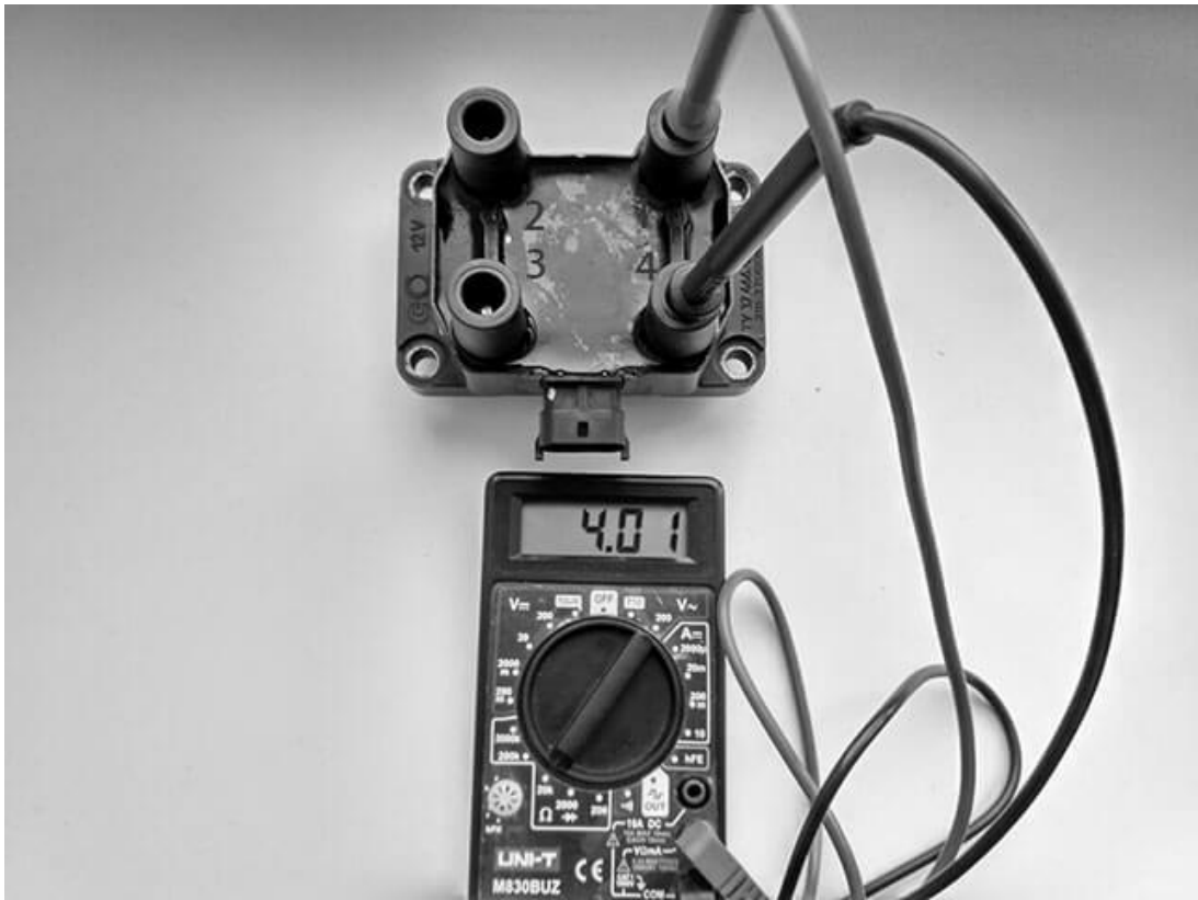
Рис. 138. Проверка вторичной обмотки катушки зажигания мультиметром
