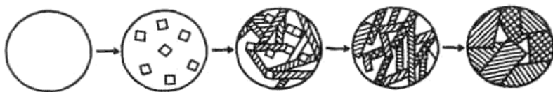
Рис. 2.3. Схема кристаллизации неорганических стекол при образовании ситаллов
