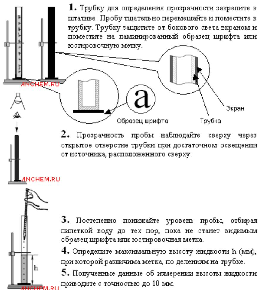
Рисунок 2.2 – Методика определения прозрачности
