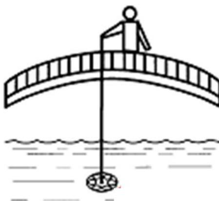
Рисунок 2.1 – Полевой метод определения мутности
