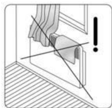
Рисунок 17 – Сушка мокрых вещей на корпусе конвектора
