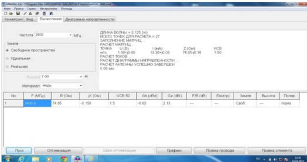
Рис. 3. Расчёт параметров антенны типа «Диполь» в программе Mmla
