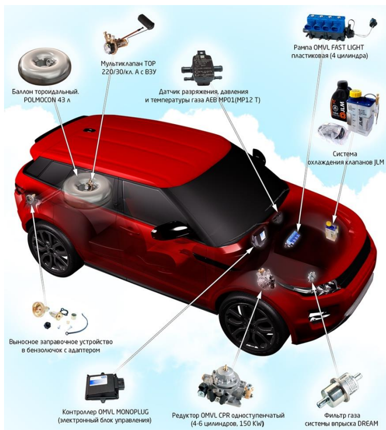
Рис.2.1. – Схема газобаллонного оборудования наиболее распространенного четвертого поколения
