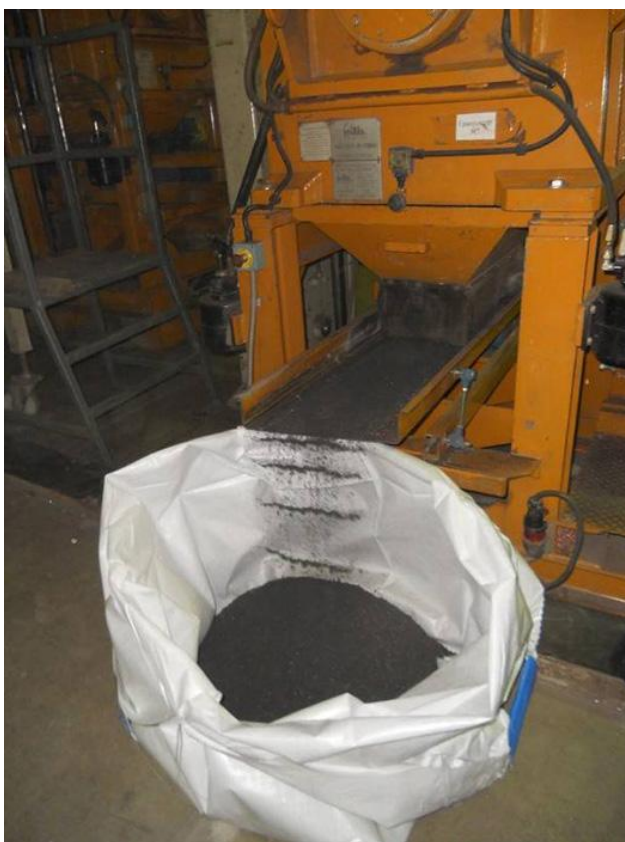
Рис. 8 Конечный продукт механической обработки. В таком виде батарейная масса поступает в химический цех [74]
