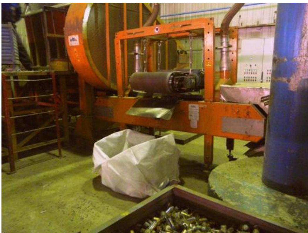
Рис. 4 Масса раздробленных батареек проходит под движущимися магнитами. В этот момент происходит отделение железа от всего остального. Железная фракция собирается в биг-бэг [74]
