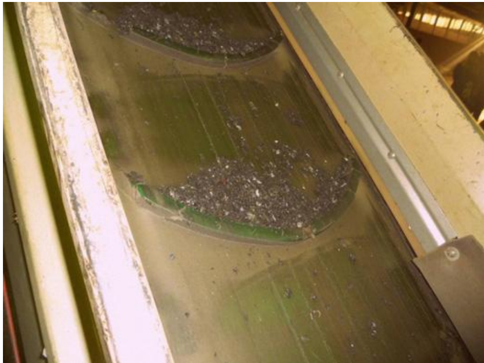
Рис. 5, 6 Отделившись от железа, батареечная масса направляется на следующий этап дробления [74]
