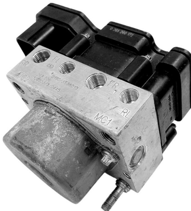
Рисунок 3 – Внешний вид гидравлического блока
