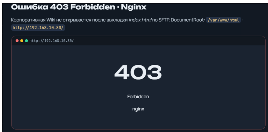
Рисунок 2 – Демонстрация искусственно вызванной ошибки доступа 403 Forbidden в браузере клиента при попытке обращения к веб-серверу Nginx (кейс №4)
