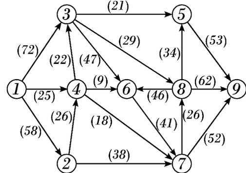
3.86. На рисунке представлена схема нефтепровода, соединяющего месторождение (пункт 1) с нефтехранилищем (пункт 8). Остальные пункты в схеме обозначают распределительные станции, регулирующие движение потоков по участкам трубопровода. Для каждого участка в схеме указана его пропускная способность. Какой максимальный поток нефти может проходить из месторождения в нефтехранилище для наиболее эффективной работы нефтепровода?
