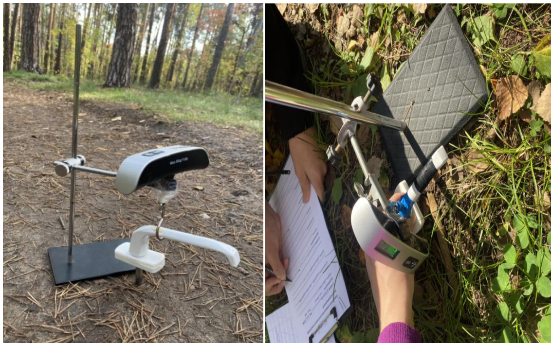
Рисунок 10– Общий вид устройства, который применялся при оценке уплотнения почвы (фото Бакуниной Т.П.)
