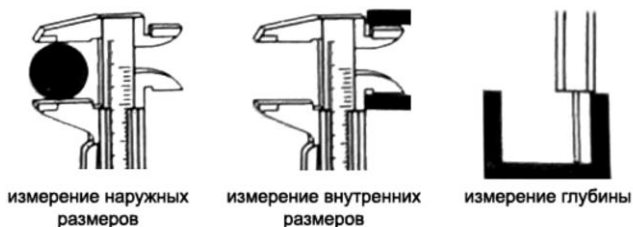
Рис. 31. Положение губок штангенциркуля и глубиномера с измеряемой деталью перед фиксированием стопорным винтом
