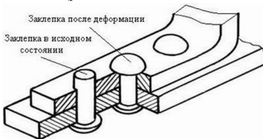
Рис. 104. Заклепки в исходном состоянии и после деформации
