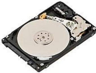
Рисунок 1.1 – 2,5-дюймовый жёсткий диск со снятой крышкой
