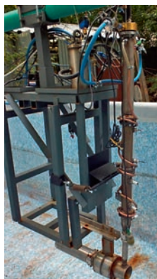
Рис. 6. Экспериментальный образец проточного импульсно-детонационного гидрореактивного двигателя на тягоизмерительной раме
